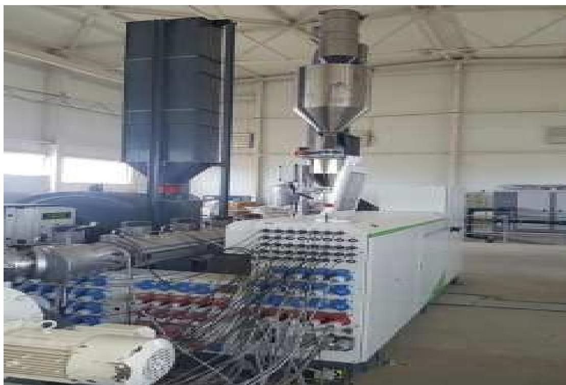
Рисунок 4 - Экструдер - для измельчения и превращения в однородную массу
