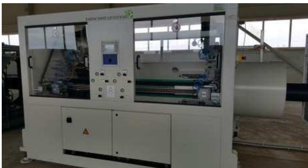
Рисунок 9 - Тянувший аппарат для вытаскивания труб из вакуумной емкости
