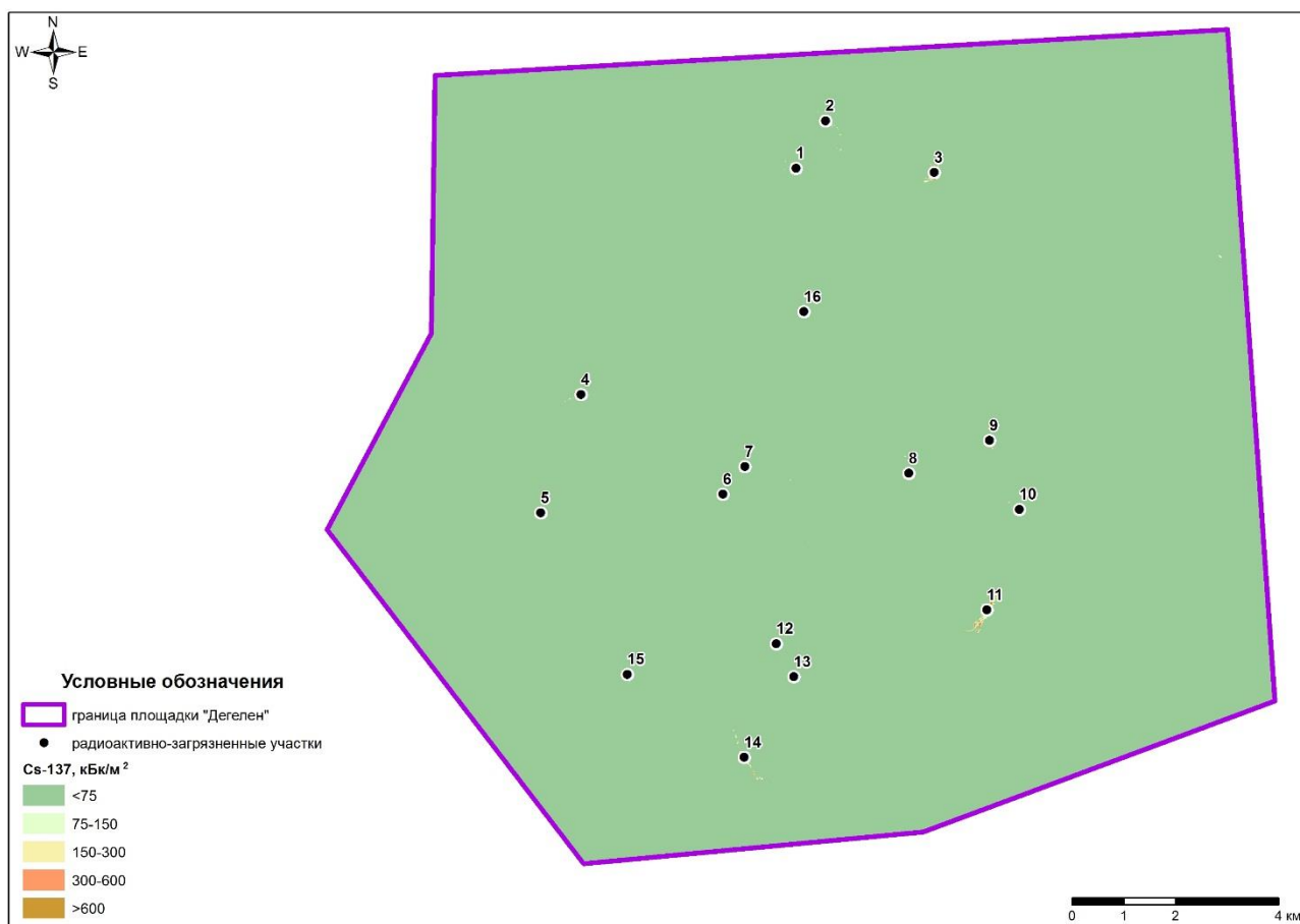
Рисунок 3. Карта-схема расположения радиационно-опасных объектов на площадке «Дегелен»
