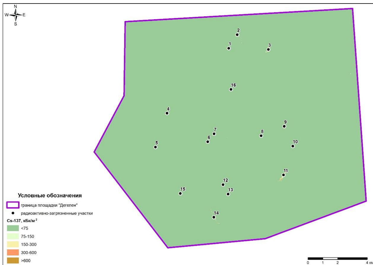
Рисунок 4. Карта-схема расположения радиационно-опасных объектов на площадке «Дегелен»
