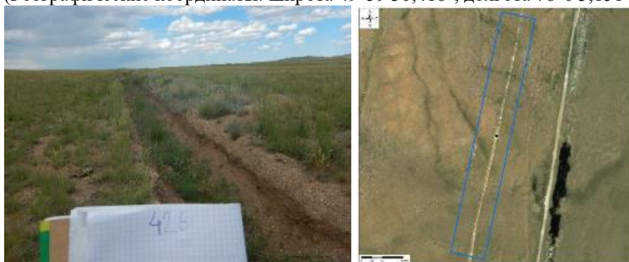
Рисунок 1136 - Объект 426. Траншея. 1,2×0,7 м (ширина/глубина), насыпь 50-70 см (Географические координаты: широта 49°59'31,721", долгота 78°0'25,731")
