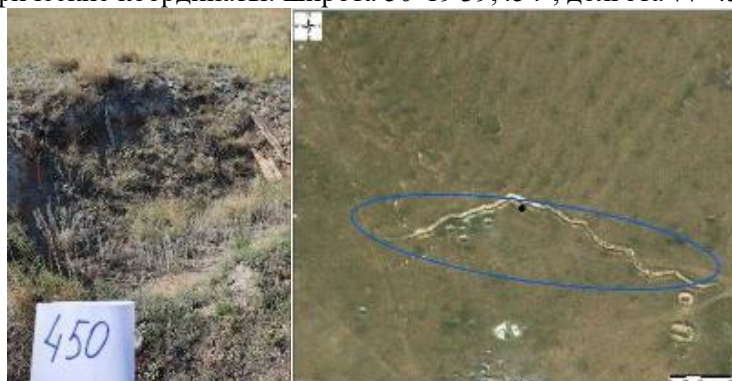
Рисунок 825 - Объект 450 Траншея 200х1х0,5м по периметру площадки, на территории ямы в виде землянок, развалины из кирпича, железобетонные сооружения (Географические координаты: широта 50°31'41,814", долгота 77°50'44,604")
