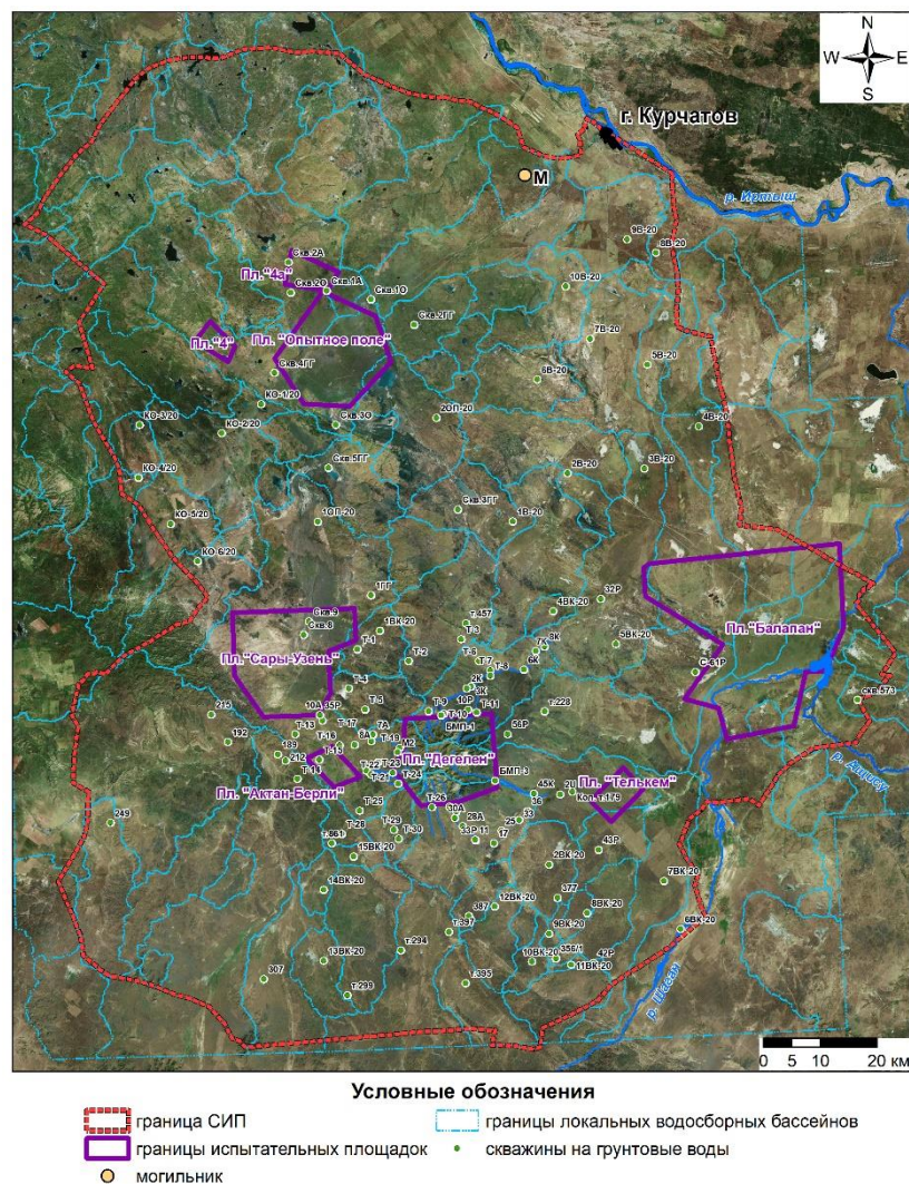
Рисунок 41. Схема расположения скважин для изучения грунтовых вод
