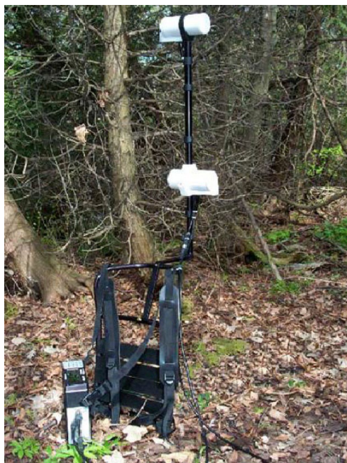
Рис. 5.11.1 Магнитометр GSM-19 в рабочем положении
