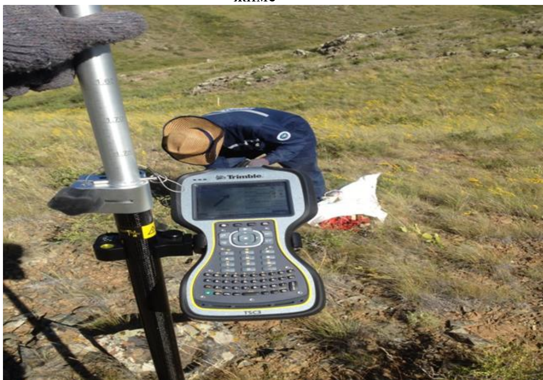
Рис 4.2. Установка GPS приемника на пункте ГГС в статическом режиме
