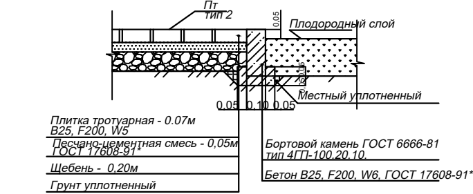
1 - 1 Сопряжение Тротуарная плитка Пт - Газон
