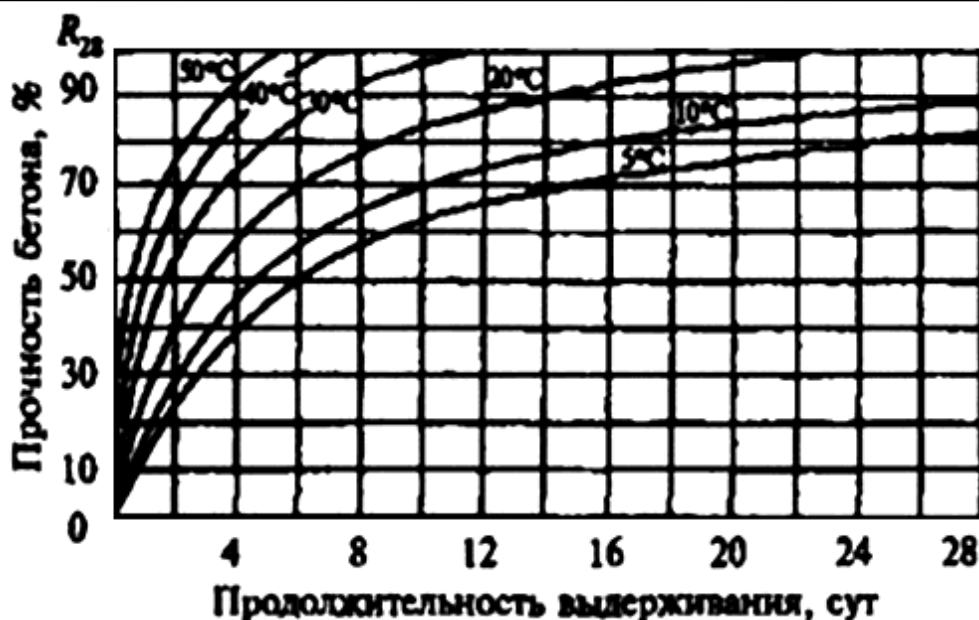
Рис.9.15.1. Прочность бетона в зависимости от температуры и продолжительности выдерживания
