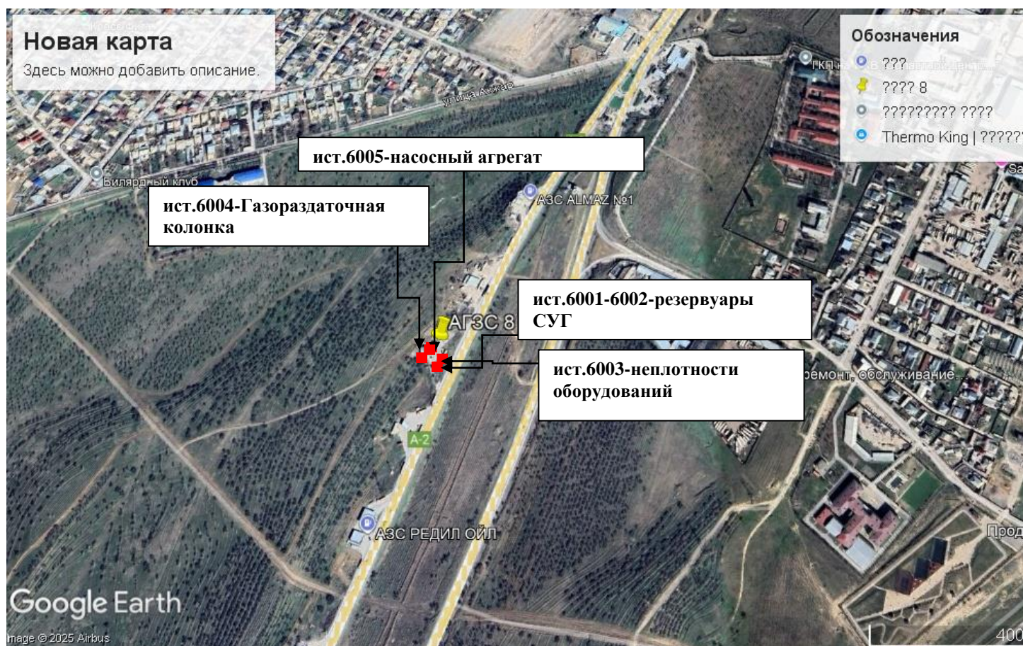
Рис. 1.1. Карта-схема объекта с нанесенными на нее источниками выбросов загрязняющих веществ в атмосферу
