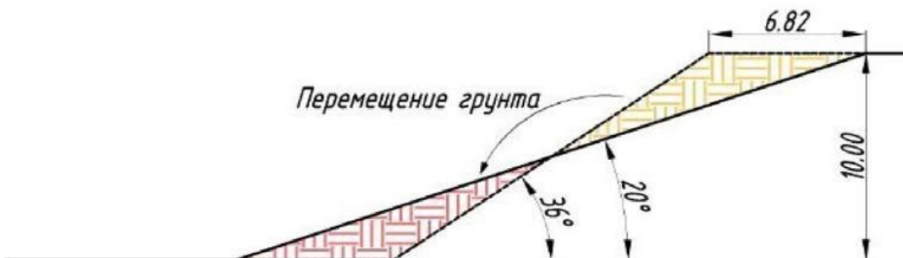
Рис.6. Типовое поперечное сечение на схеме выполаживания отвала
