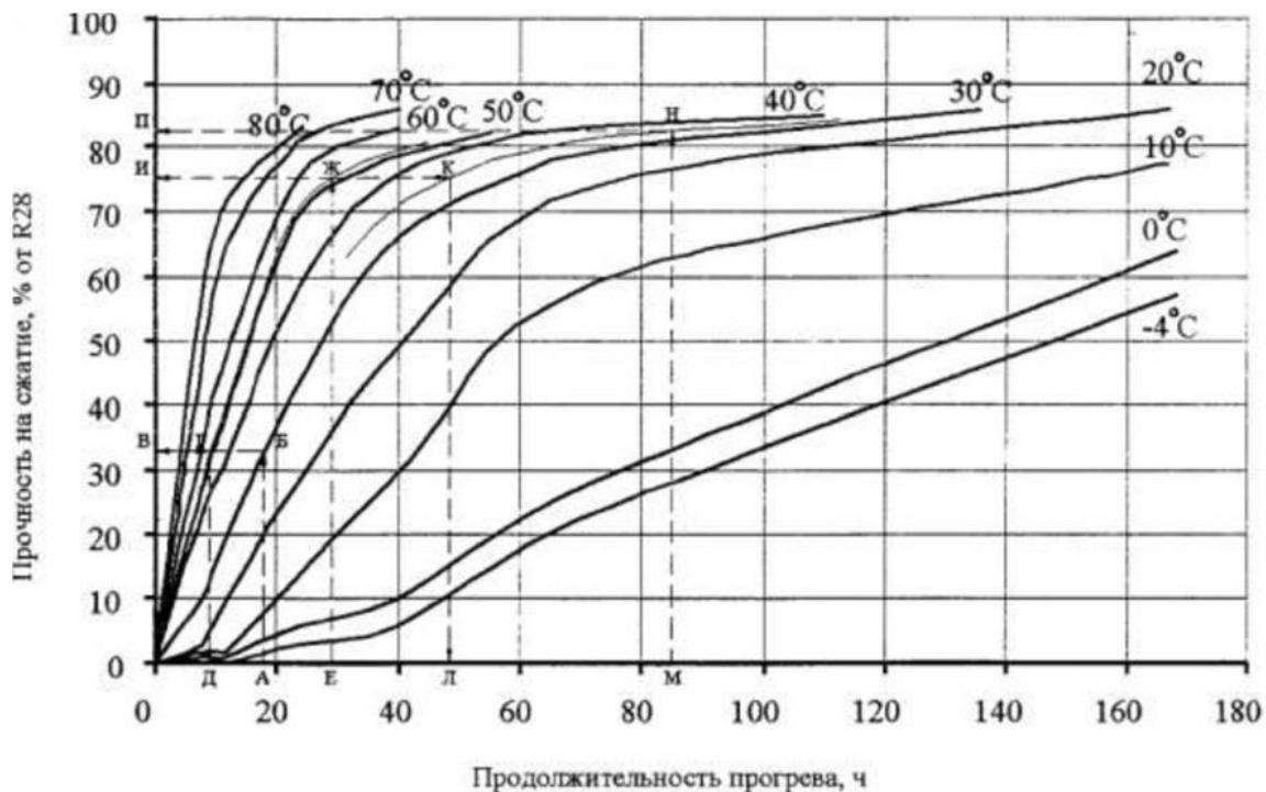
Определяем прирост относительной прочности бетона при изотермическом прогреве за 20 ч. Из точки В проводим перпендикуляр до кривой прочности при 52°C (точка Г) и опускаем перпендикуляр на оси абсцисс (точка Д). Из точки Д откладываем по оси абсцисс 20 ч. (точка Е), откуда проводим перпендикуляр до кривой прочности 52 °C (точка Ж). Проекция участка ГЖ кривой прочности 52 °C на оси ординат (ВИ) составляет 43% от R28.
