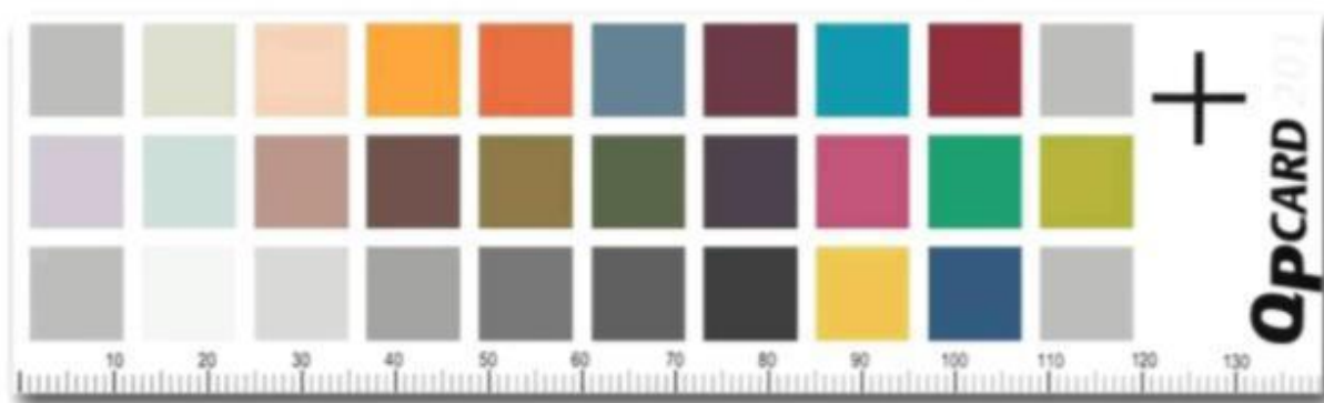
Рисунок 5-7 - Пример цветной/черно-белой контрольной полосы, которая может быть использована для корректировки цветового баланса.
