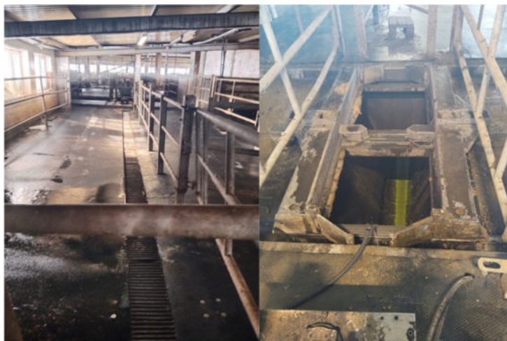
Рисунок 2 Удаление навоза дельта-скреперами в поперечный канал
