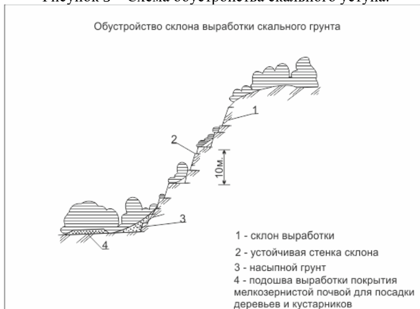
Рисунок 3 – Схема обустройства скального уступа.
