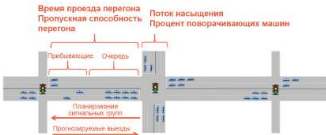
Рис. 7.1. Ключевые элементы прогноза состояния трафика в системе ImFlow
