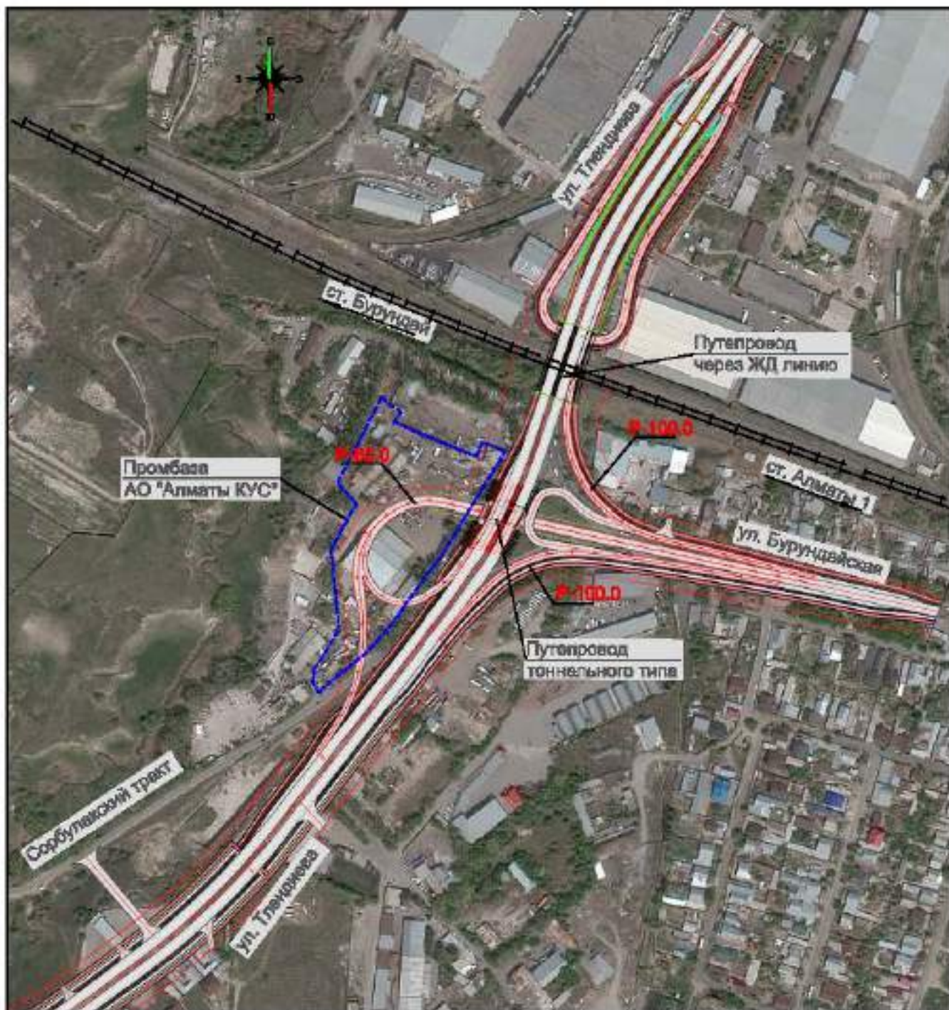
Рис. 4.1. Схема развязки вариант 1
