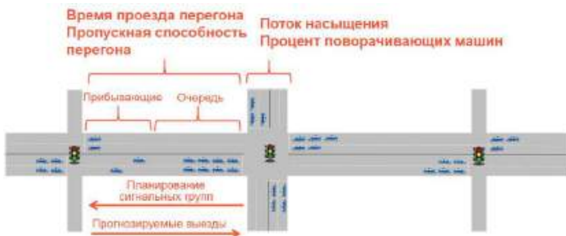
Рис. 7.1. Ключевые элементы прогноза состояния трафика в системе ImFlow
