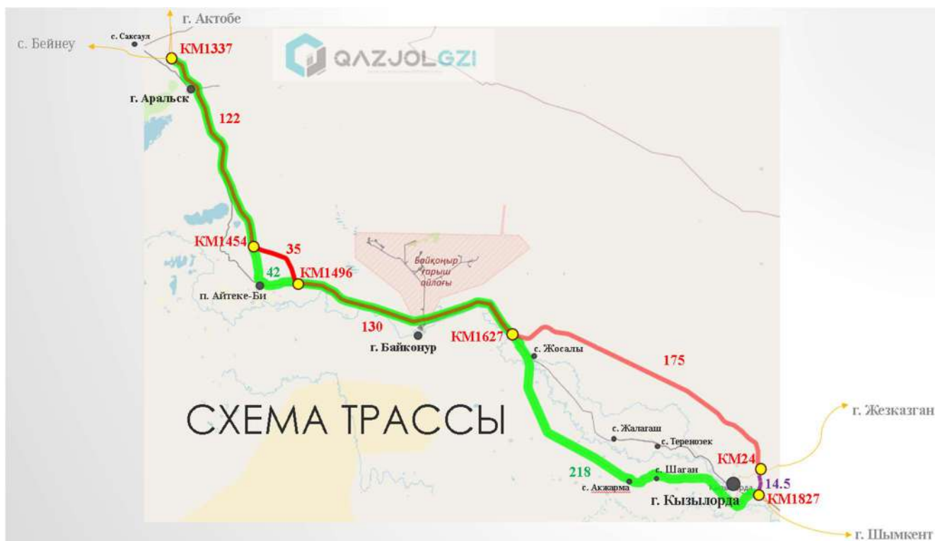
Рисунок 7 Схема спрямления КМ1827-КМ1627 принятый вариант
