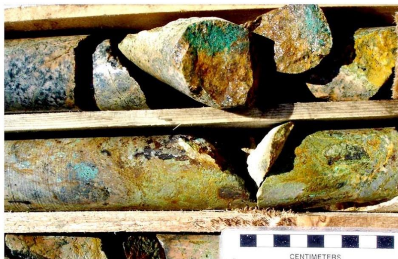
Рисунок 4.3 - Смешанные руды с малахитом по кварц-сульфидной жиле. Содержание меди в пробе-1,4%. Скважина ВАІ- 9, глубина 27,5 м
