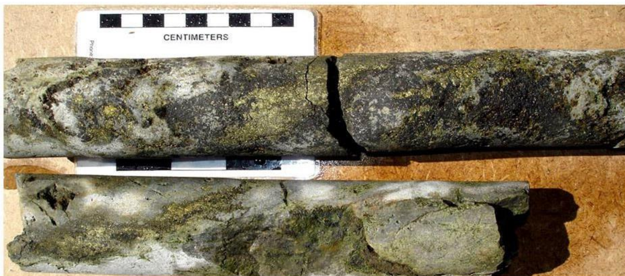
Рисунок 4.8 - Кварц-сульфидное жильное образование с халькопиритом пиритом, борнитом и вторичным халькозином. Скважина ВАІ-9: глубина 57,0 м; медь - до 7,2%; золото - 0,3 г/т.
