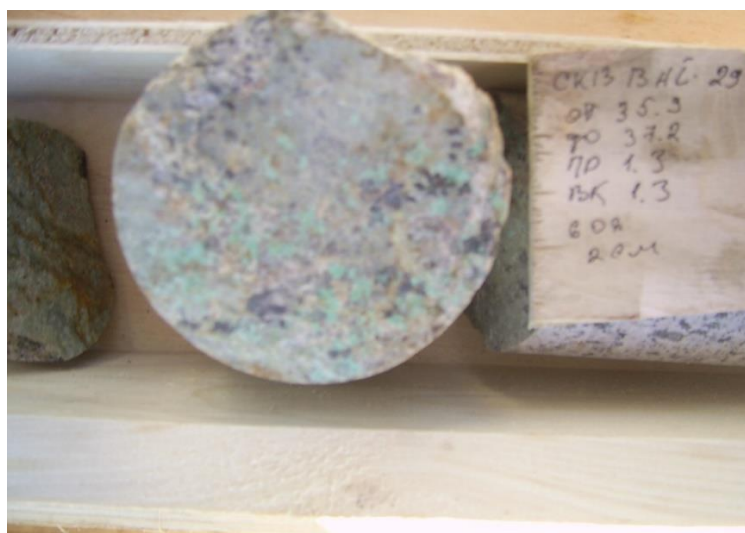
Рисунок 4.4 - Малахитовые руды в гранодиоритах, по вкрапленным сульфидным рудам
