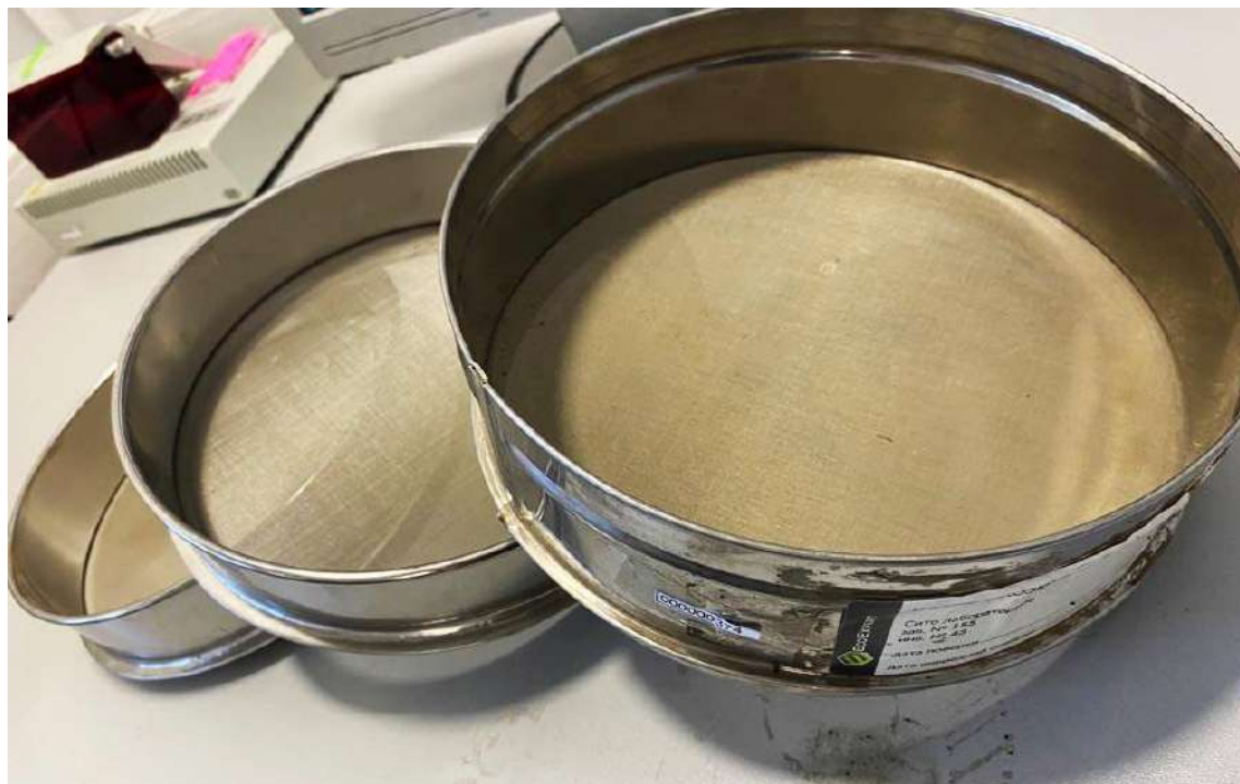
Рисунок 3.2.4 - Набор сит для получения фракции 10 мкм
