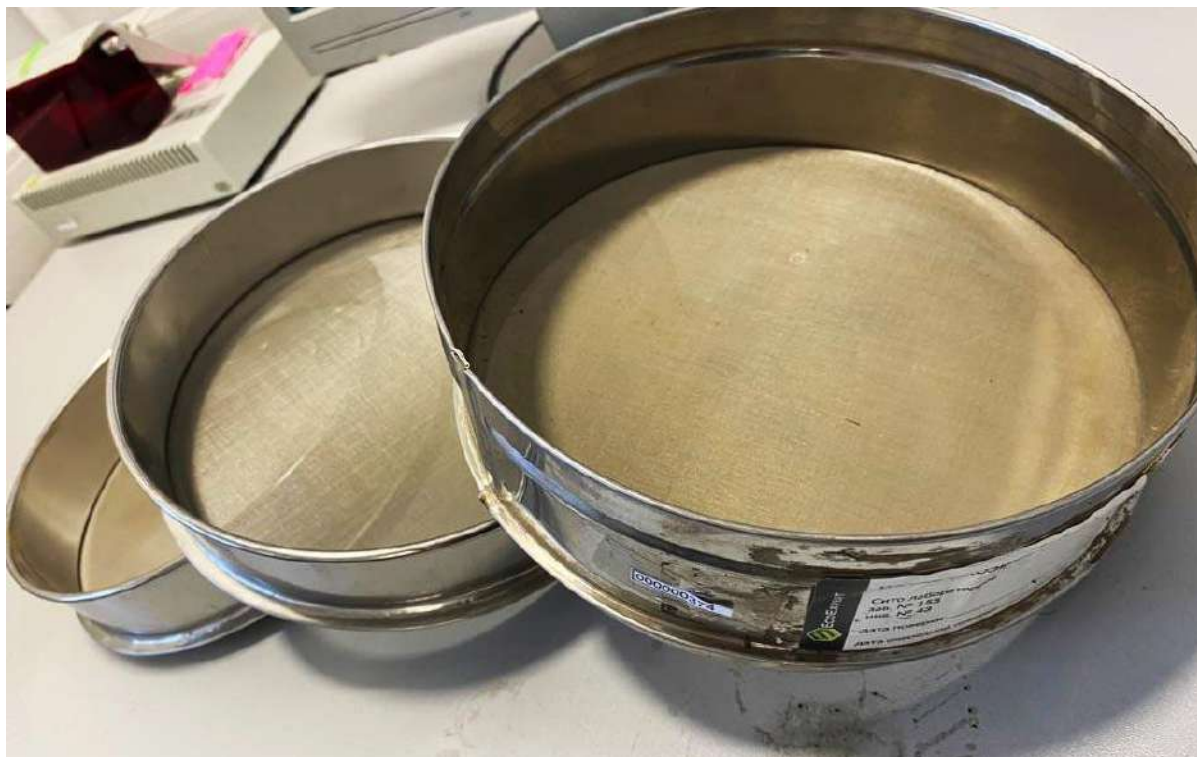
Рисунок 3.2.3 - Набор сит для получения фракции 10 мкм
