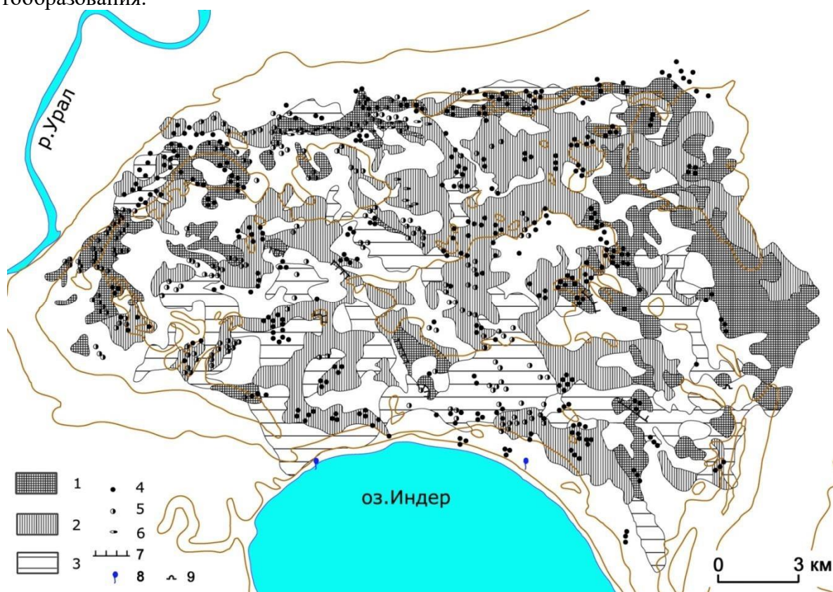
Рис. 4.3. Индерская денудационно-карстовая возвышенность (по Яцкевич, 1937, с дополнениями) Условные обозначения: 1 – сильнозакарстованные участки; 2 – среднезакарстованные участки; 3 – слабозакарстованные участки; 4 – блюдцеобразные воронки полностью или частично задернованные; 5 – конусообразные воронки открытые или частично задернованные; 6 – понорообразные и колодезевые воронки открытого типа; 7 – карстовые гряды («курган-тау»); 8 – родники (источники высокоминерализованных вод); 9 – пещера.
