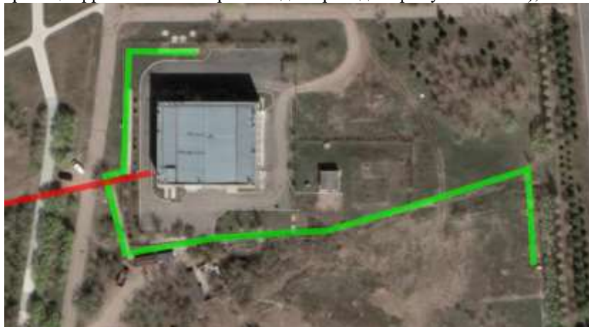
ПС Заречная (Ремонт каб.канала ПС Заречная – выход к спецтрассе) , КЛ-9
