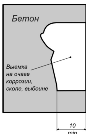
Рис. 5.5.5. Типовая схема подготовки кромок паза
