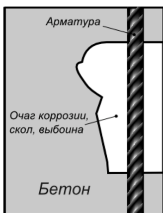
Рис.5.5.4. Типовая схема подготовки паза на участке с оголённой арматурой
