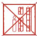
нет тяги (Не используйте котел!)
