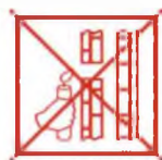
недостаточная тяга (Не используйте котел!)
