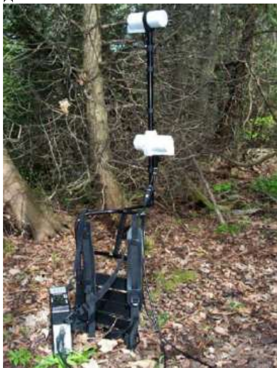
Рис. 5.3 Магнитометр GSM-19 в рабочем положении
