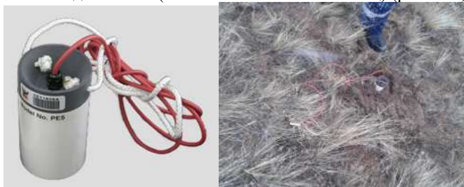
Рис. 5.13 - Неполяризующийся малошумящий электрод PE5
