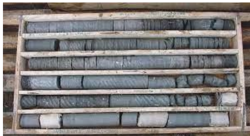
Рис 1.2 Керн размещенный в керновом ящике
