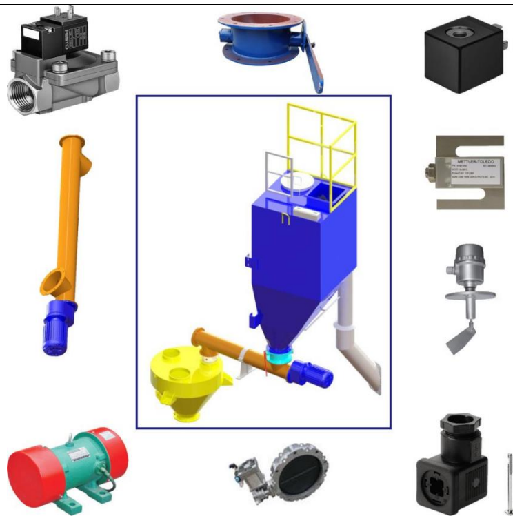
Рисунок 2-9-1 Схема системы подачи минерального порошка 1--- бункер временного хранения минерального порошка 2---перекидной клапан 3---выпускная труба 4—шнек 5---бункер-дозатор
