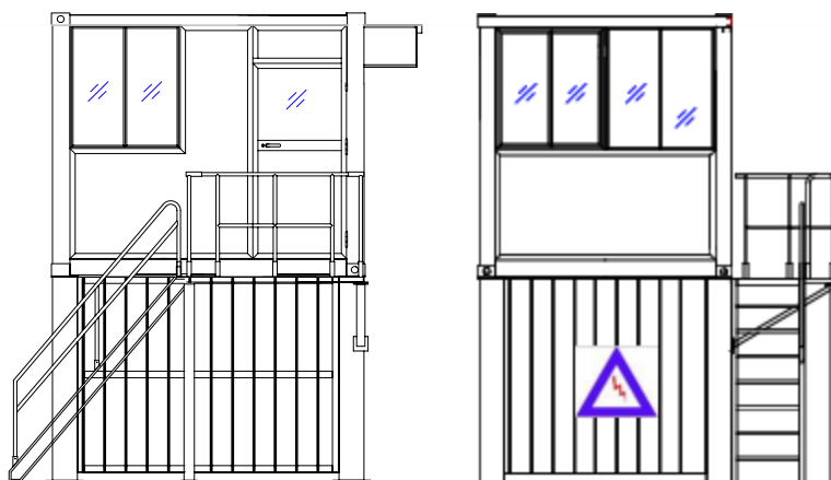
Рисунок 2-15-1 Структурная схема кабины управления
