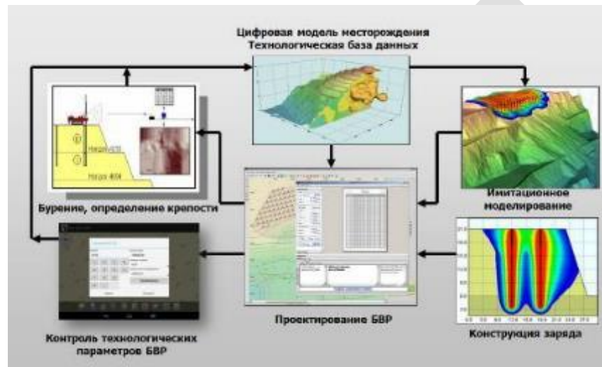
Рисунок 7.7. Схема АСУ буровыми работами
