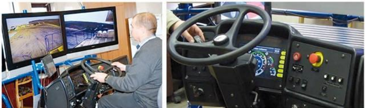
Рисунок 7.3. Кабина оператора беспилотного БелАЗа
