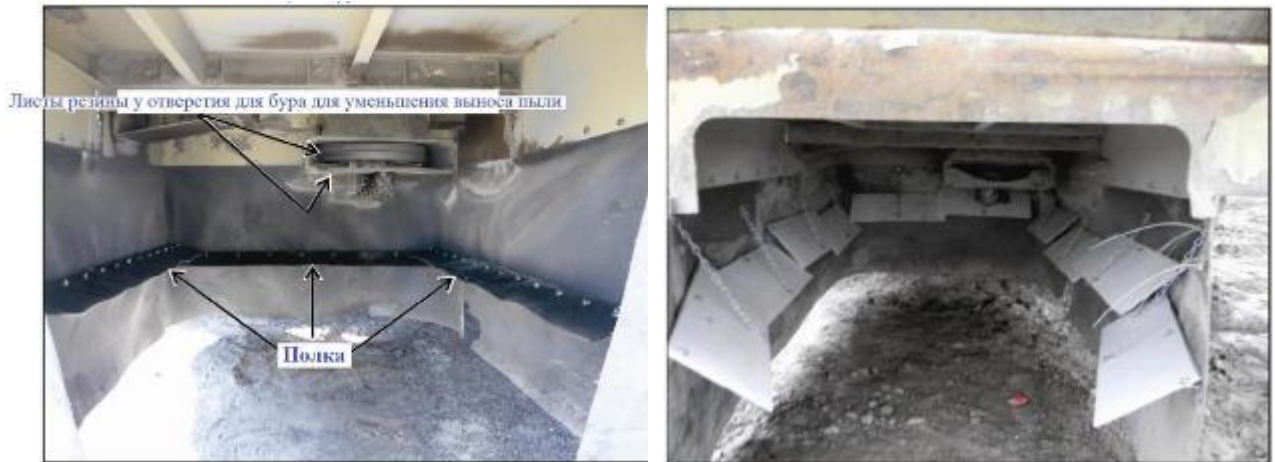
Рисунок 5.6. Отклоняющие пылевой поток полки в ограждении
