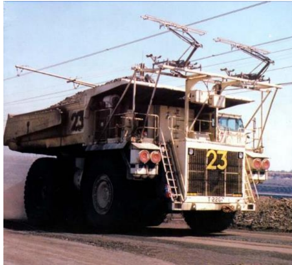
Рисунок 7.4. Карьерный самосвал Siemens – троллейвоз
