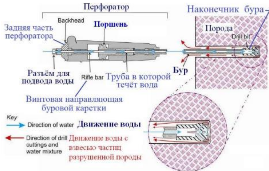
Рисунок 5.3. Схема движения воды при мокром бурении скважин и шпуров ручными перфораторами
