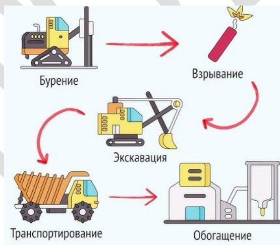
Рисунок 3.1. Схема технологического процесса открытых горных работ
