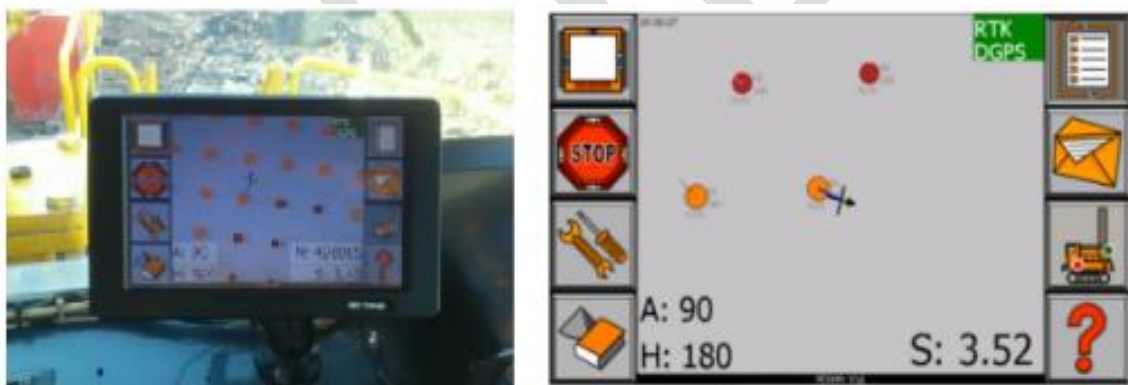
Рисунок 5.1. Оборудование, установленное в кабине бурового станка и интерфейс программы
