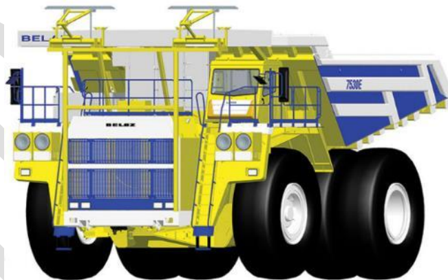
Рисунок 7.6. 3D-проект дизель-троллейвоза БЕЛАЗ
