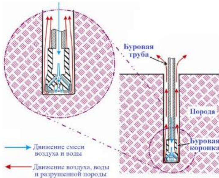
Рисунок 5.2. Движение воздушно-водяной смеси при мокром методе пылеподавления
