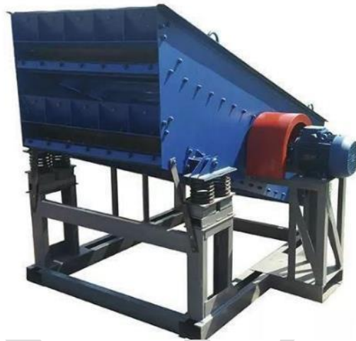
Рисунок 3.5. Типовой инерционный грохот ГИТ
