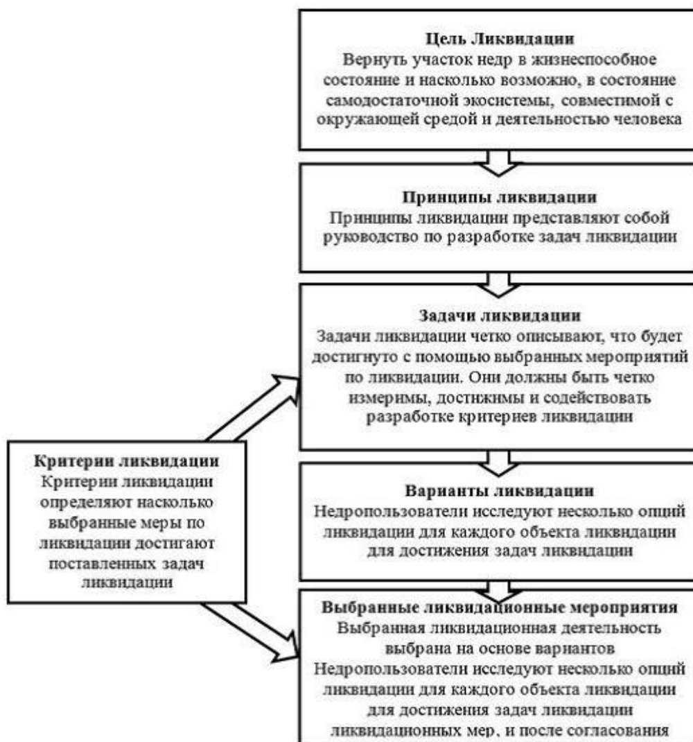
Рис.5.1 Схема планирования ликвидации
