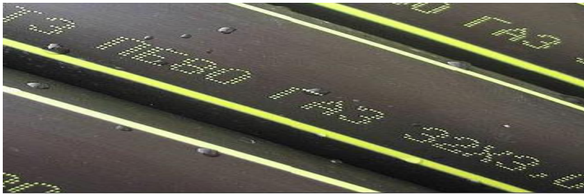
Рисунок 2.5.2.1 - Маркировка полиэтиленовых труб
