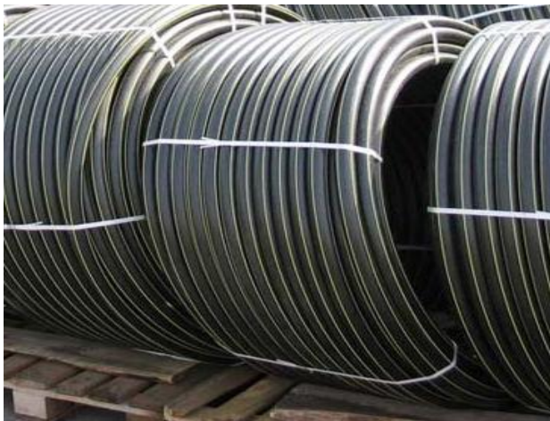
Рисунок 2.5.2.2 - Бухты и прямые отрезки полиэтиленовых труб
