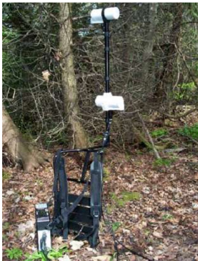
Рис. 4.3 Магнитометр GSM-19 в рабочем положении
