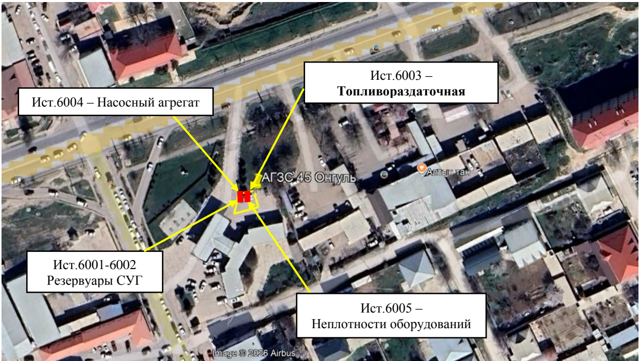
Рис. 1.1. Карта-схема объекта с нанесенными на нее источниками выбросов загрязняющих веществ в атмосферу
