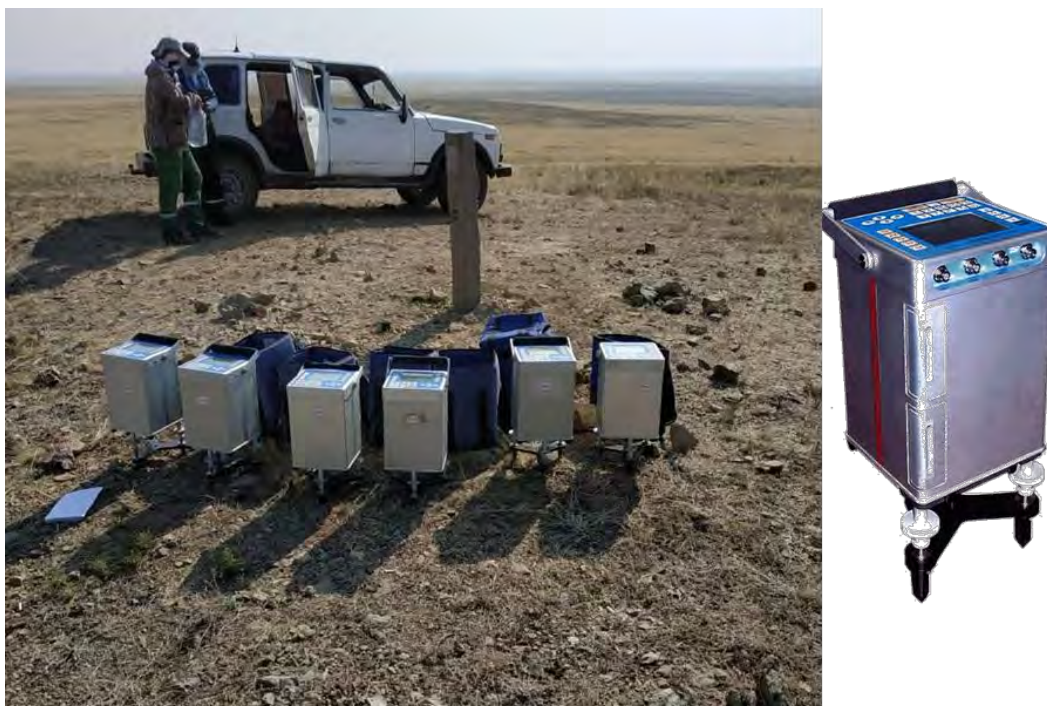
Рис.2.11. Внешний вид гравиметра CG-5 AutoGrav Scintrex. Оборудование для выполнения гравиметрических исследований.
