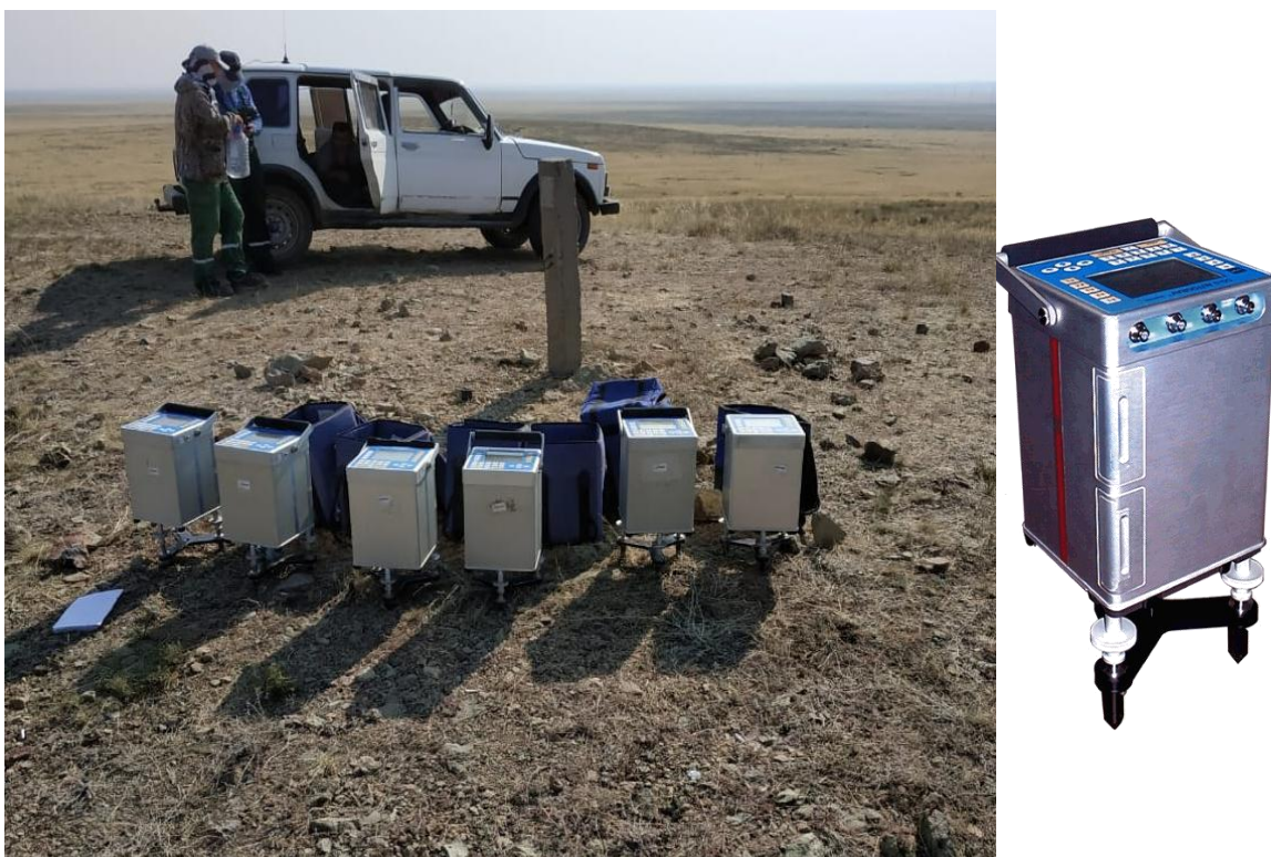
Рисунок 3.8 Внешний вид гравиметра CG-5 AutoGrav Scintrex
