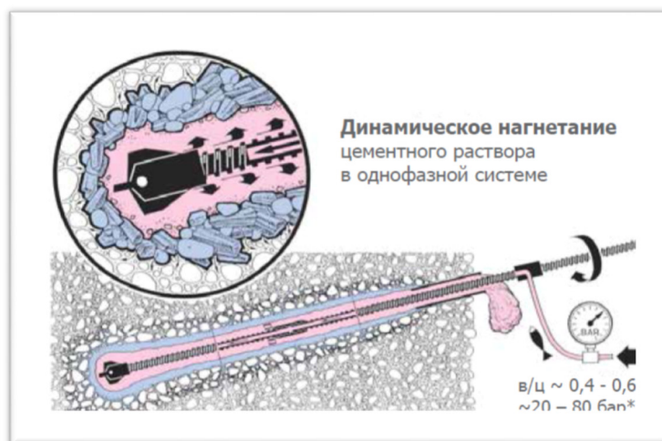
Рис.2 Нагнетание цементного раствора
