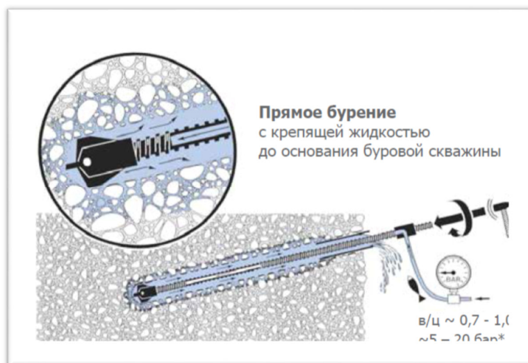
Рис.1 Бурение с промывкой
