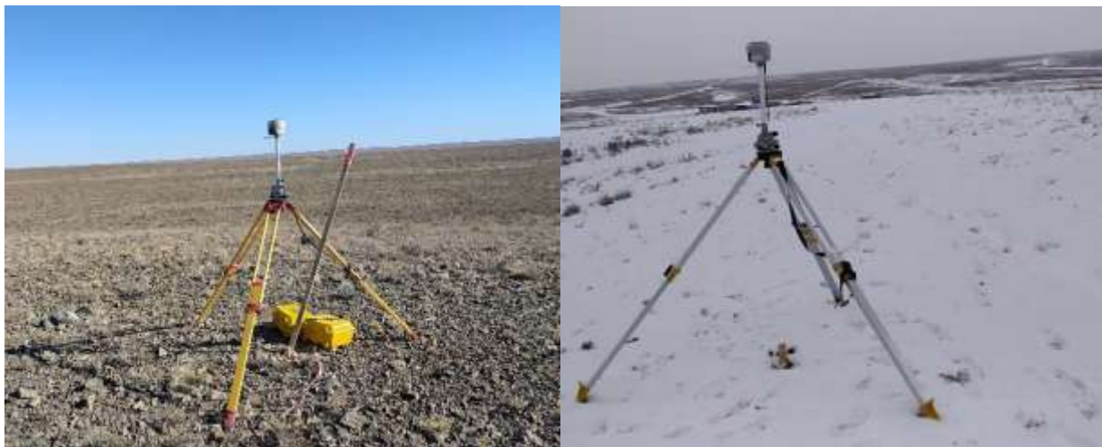
Рисунок 17. Высокоточный 72-канальный приемник Sokkia GRX1
