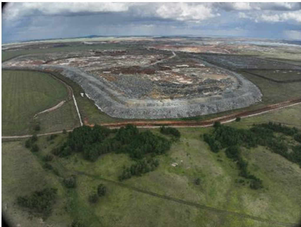
Рисунок 1.3.6. Отвалы вскрышных пород на территории рудника
