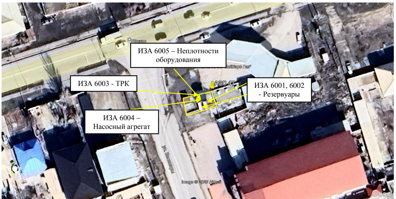
Рис. 1.1. Карта-схема объекта с нанесенными на нее источниками выбросов загрязняющих веществ в атмосферу
