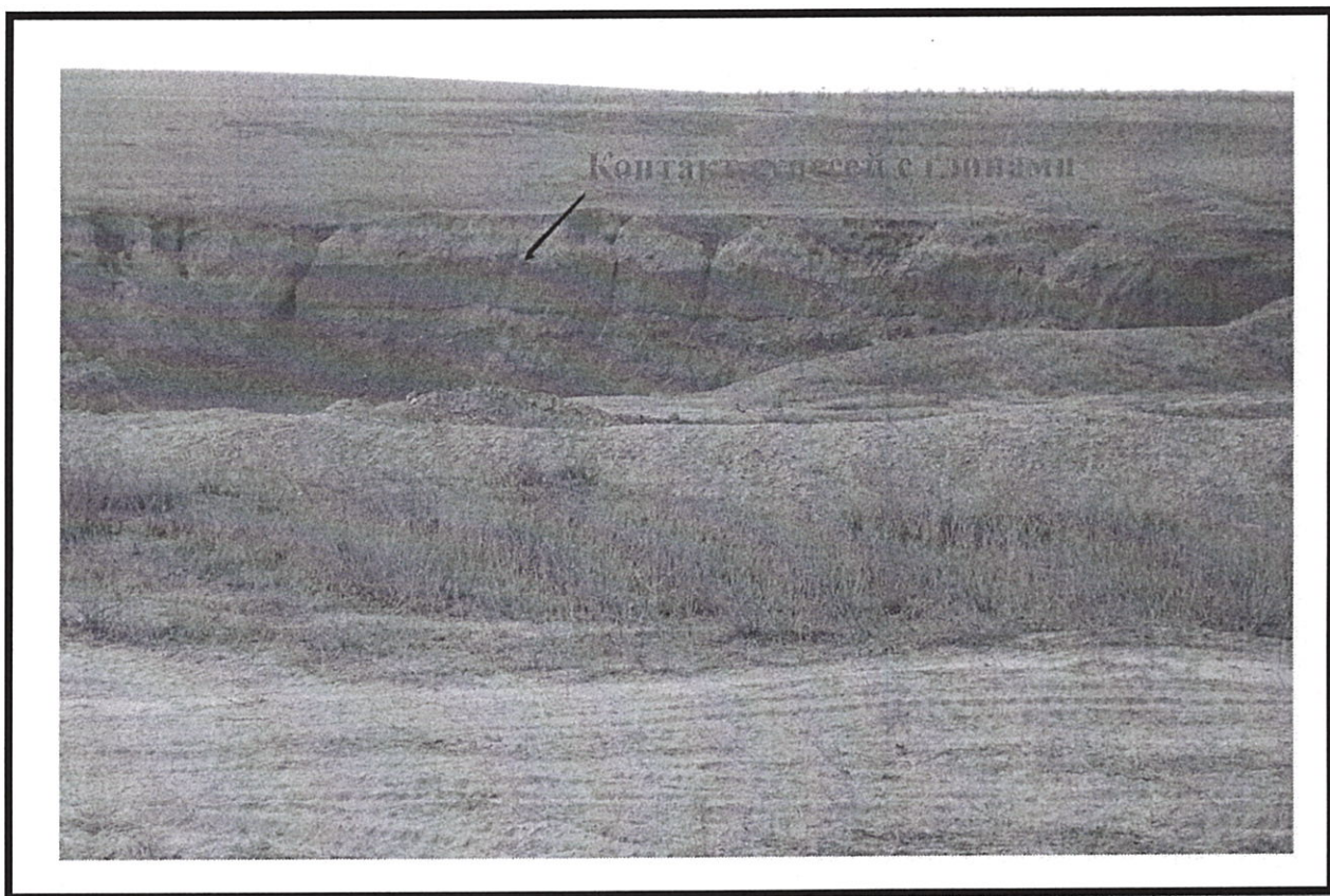
Рис.4 Контакт супесей с глинами полезной толщи в карьере Коскудукского месторождения глин пластификаторов.
