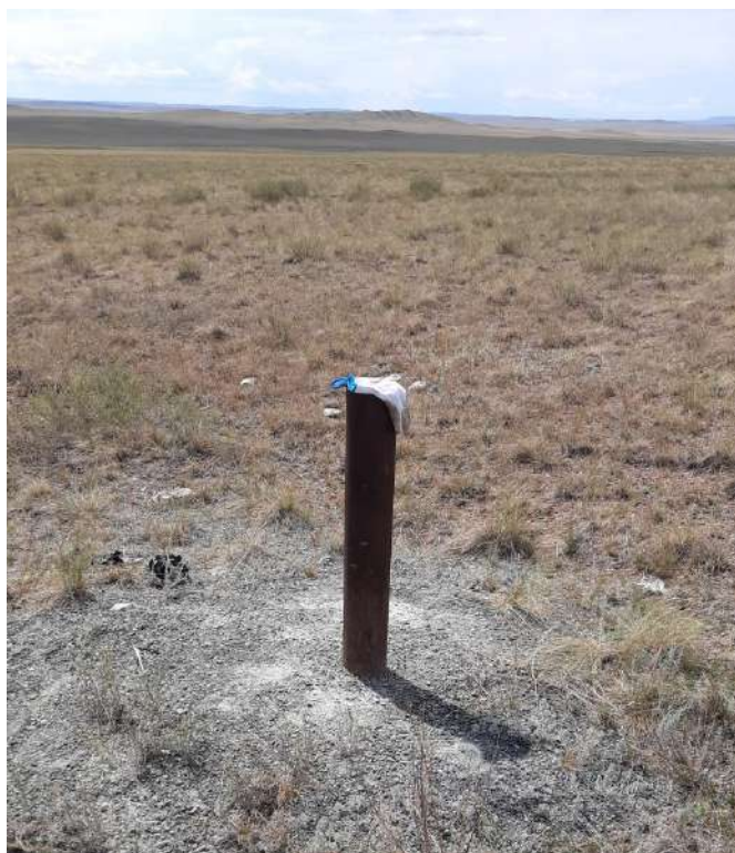
Рисунок П.1.2. Гидрогеологическая скважина на территории месторождения
