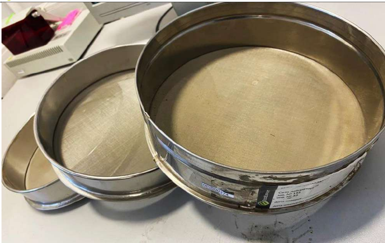
Рисунок 3.2.7 - Набор сит для получения фракции 10 мкм
