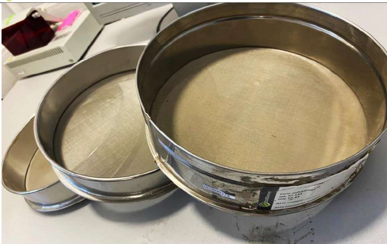
Рисунок 3.4 - Набор сит для получения фракции 10 мкм
