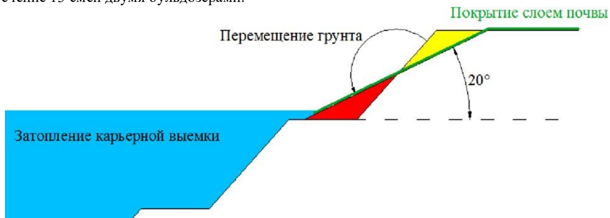
Рис. 5.3.1.1 – Схема выполаживания верхнего уступа карьеров
