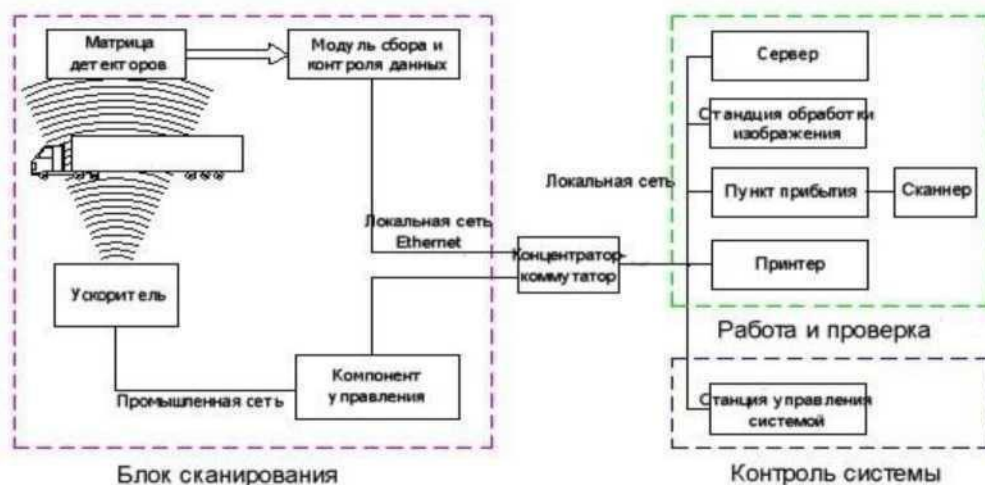
Рисунок 8. Логическая схема инспекционно-досмотрового комплекса NUSTECHTM FS6000MKK+ (только в качестве примера)
