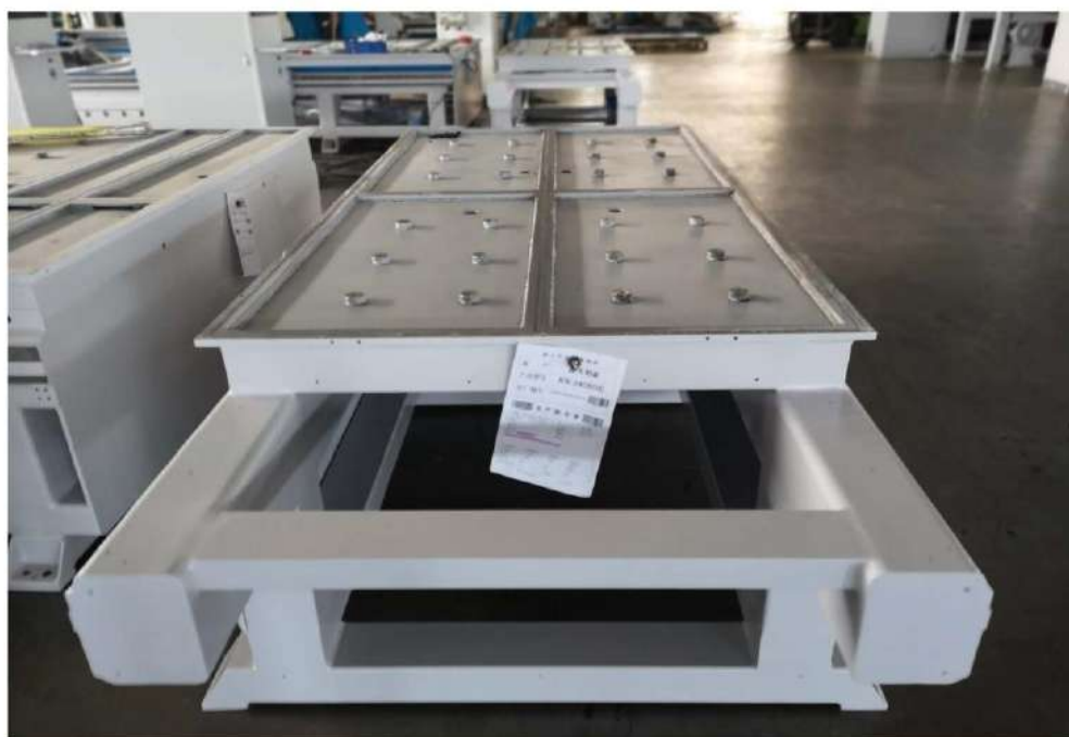
Станина и портал после сварки, для снятия внутренних напряжений, отжигаются в специальной печи и затем обрабатываются на тяжёлом портальном фрезерном центре за одну установку.
