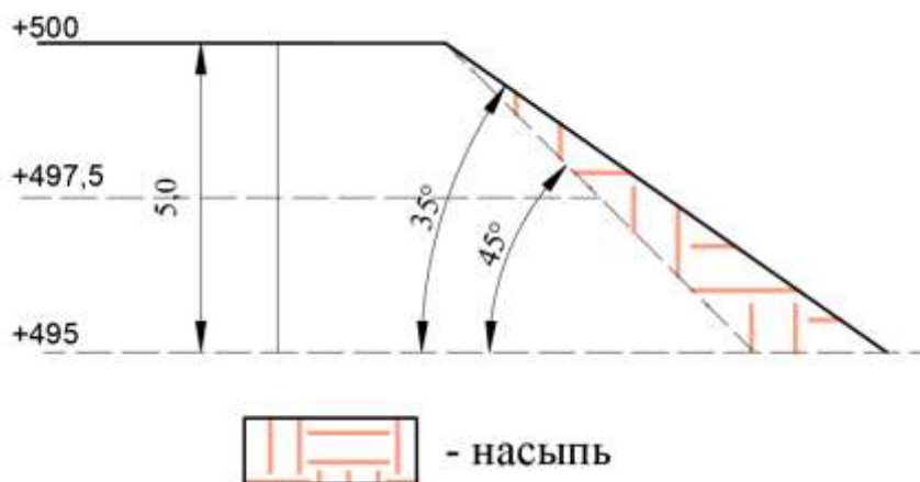
Рисунок 5.4 – Схема частичной засыпки выработанного пространства с выполаживанием верхнего уступа до 35^{\circ}
