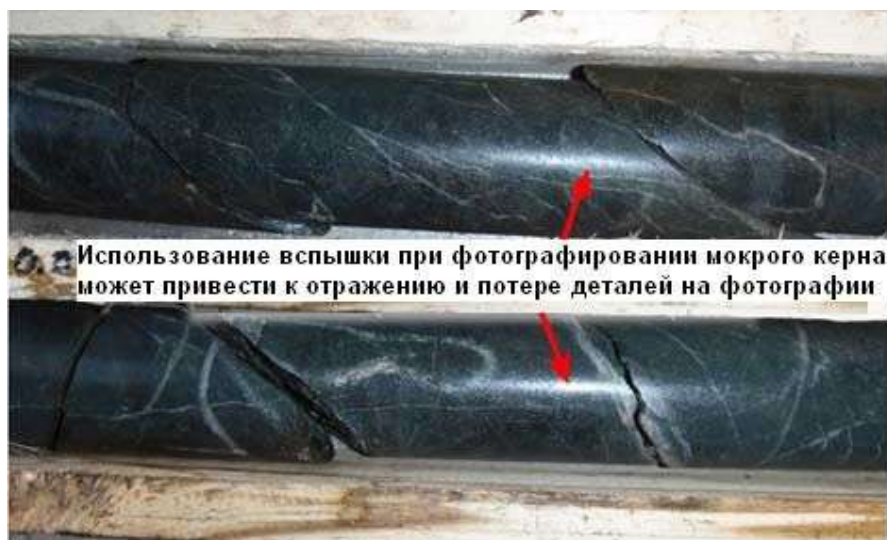
Рис. 14 – Фотографирование керна. Следите за тем, чтобы керна не был слишком влажным, и при возможности не используйте вспышку, так как это может привести к появлению на снимке засвеченных мест.
