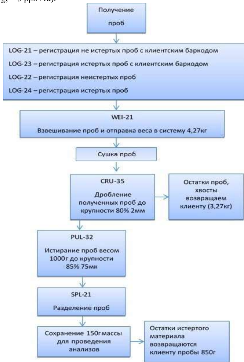
Рис. 20. Схема обработки проб по международному стандарту (лабораториями компании ALS)
