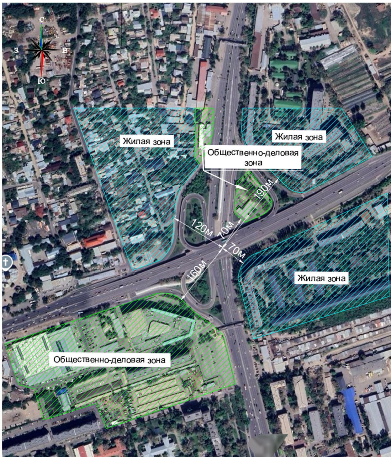
Рис. 8.1. Схема ремонтируемого участка с санитарно-защитным разрывом и расстоянием до ближайших жилых домов
