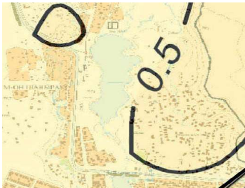
Рис 4. Выкопировка из Вероятностной Карты сейсмического микрозонирования в пиковых ускорениях грунта для периода повторяемости 475 лет
