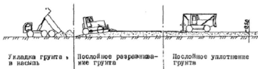
Рис. 9.3.1. Технология возведение насыпей.
