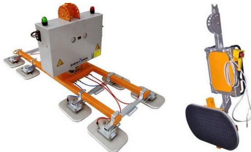
Рис. 9.7.1. Вакуумные захваты для сэндвич-панелей
